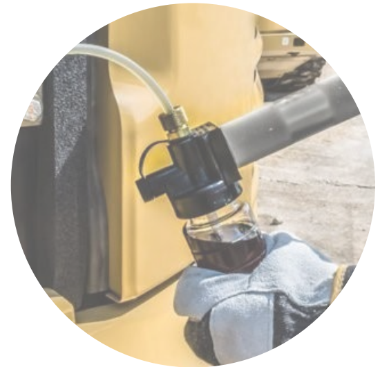
Una toma de muestra detecta fallos en el aceite
